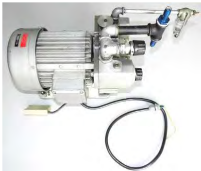
Vakuumpumpe 220V/380 3 1/8A IP54 50Hz. Bell+Howell CE,CEX,CEXP Art.-Nr.: LB 099.01 gebraucht Preis pro Stück:
