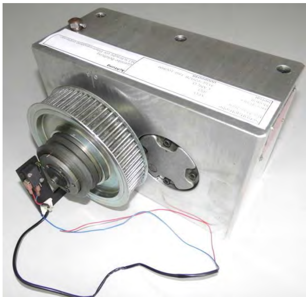
Abb. 5, 41, 8/38 Schrittgetriebe komplett CAMCO Commercial Cam.Co.Ink. Model M387P2H28-180 / 100MM Serie 00089048 (bh597866-001 / 043153-0001) Synchronkupplung kpl. (bh048310) mit Zahnriemenrad (bh410416-6401) und Überlastkupplung Scheibe (bh414687) Halter für Schalter (bh414803) Mikroschalter m. Zwangstrennung (bh412810-0001) Bell+Howell XPO / C4 Post Star JPO gebraucht überholt und funktionsfähig Art.-Nr.: LB 101 Preis pro Stück:
