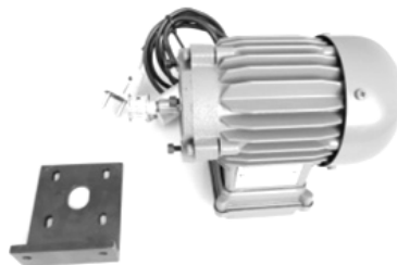
Emod Motor Typ 56L/4 EHB – Isol.Kl.B – Mot.-Nr.02937988 – IP54 – KW 0,07 – S1 – V220 – A0,95 – n1430 – COS 0,92 – Hz50-CB6UF Bell+Howell CE, CEX, CEXP/XPO/JPO Art.-Nr.: 8435.02 gebraucht Preis pro Stück:
