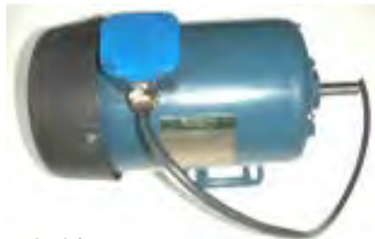
Antriebsmotor , kpl. MMA 584TF 3G 167 220/380V – 4,8 / 2,8 A – 1,1 kW/50Hz 1425 U/min. Bell+Howell CE, CEX, CEXP Art.-Nr.: 8436 gebraucht Preis pro Stück:
