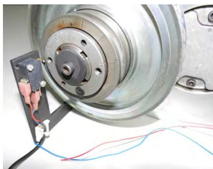
Abb. 5, 41, 8/38 Schrittgetriebe komplett CAMCO Commercial Cam.Co.Ink. Model M387P2H28-180 / 100MM Serie 00089048 (bh597866-001 / 043153-0001) Synchronkupplung kpl. (bh048310) mit Zahnriemenrad (bh410416-6401) und Überlastkupplung Scheibe (bh414687) Halter für Schalter (bh414803) Mikroschalter m. Zwangstrennung (bh412810-0001) Bell+Howell XPO / C4 Post Star JPO gebraucht überholt und funktionsfähig Art.-Nr.: LB 101 Preis pro Stück:
