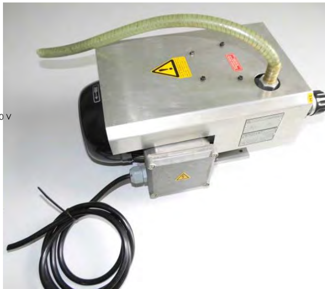
Motorgehäuse innen beschildert mit: AEG Typ AM80NY4Q4 IMB9 IEC60034 3-Mot No 500911352 Th.Cl F(F) IP54Termally Protected 50Hz:Δ/Y200/440V 0,55kW 60Hz:Δ/Y200/440V 0,65kW 1390/1630min -1 50Hz:200-255/346-440V 3.1/1.8A 60Hz:200-255/346-440V 3.4/1.95A Bell+Howell XPO/JPO Art.-Nr.: LB 099.04 gebraucht Preis pro Stück:
