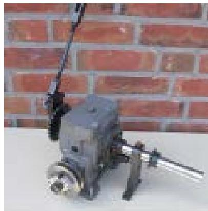
HASE GEAR Getriebe – Typ BHB63
