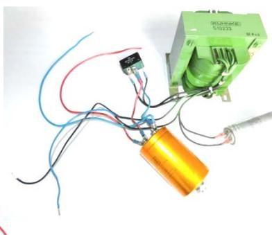
**Transformator mit Kondensator KUHNE S10233** (bh 401127-2000)
