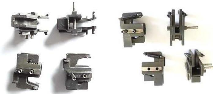
**Zangenkörper** (bh 542023)(Body-envelope chain) mit **Zangengreifer** (bh 542051)(Support-jaw & Spring) mit je 2 Zugfedern DS 0,7 DA 5,6 LO 21 (bh 542070) - Ref. Chain envelope drive
