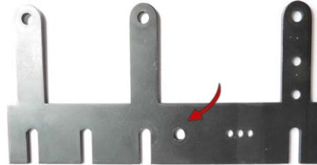
**Saugerhalter Platte zur Kuvertentnahme**
